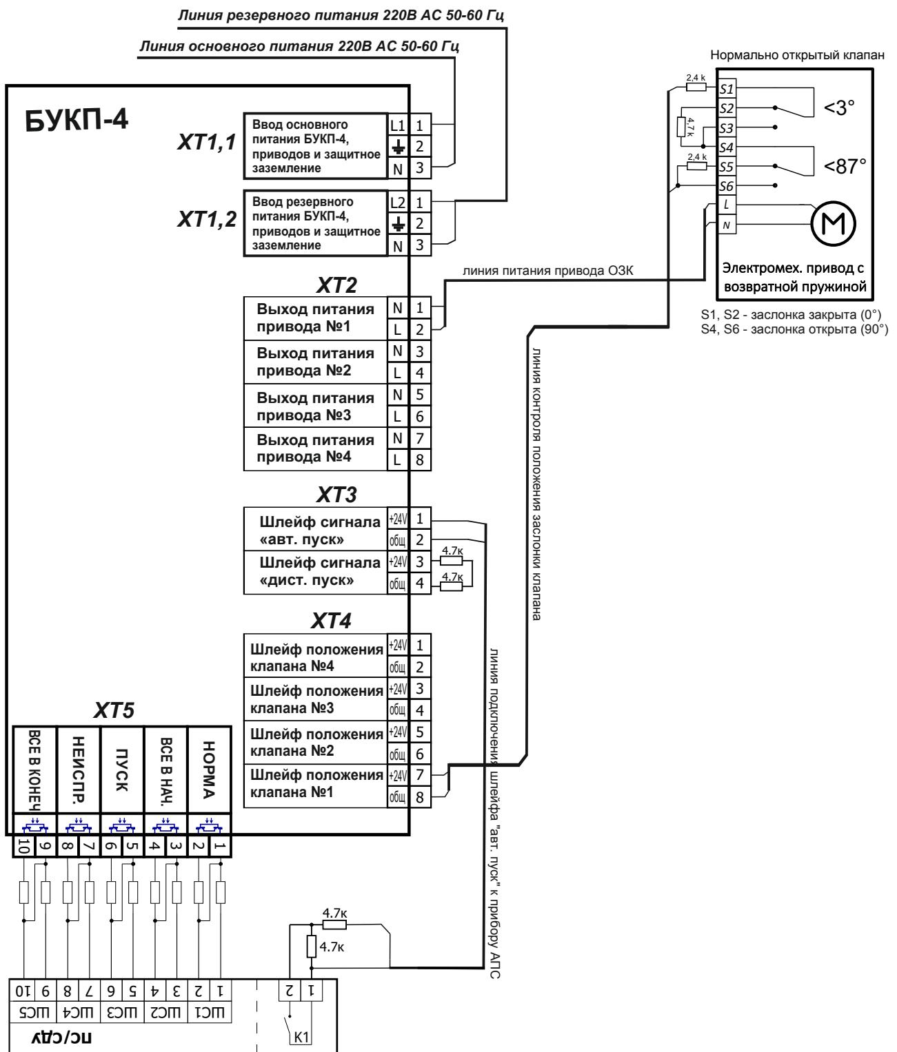
На схеме указан пример подключения питания и шлейфа состояния одного привода. Остальные приводы подключаются аналогично. Обратите внимание, не подключенные приводы должны быть **заблокированы** ДИП переключателями соответственно их порядковому номеру.
